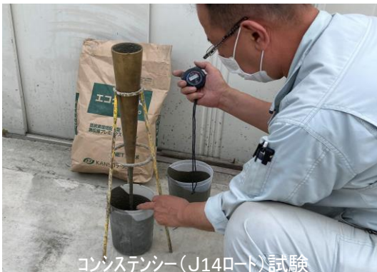
コンシステンシー(J14ロート)試験
