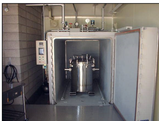
図4 オートクレーブによる高温高压処理
