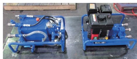
左:コントロールユニット 右:パワーユニット
