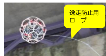
ヒモ取り付けによる 逸走防止 (橋梁支保脚)
