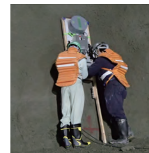
FDEMによるトンネル切羽前方探査
