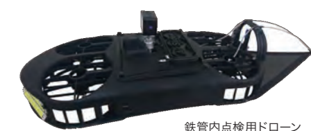
鉄管内点検用ドローン
